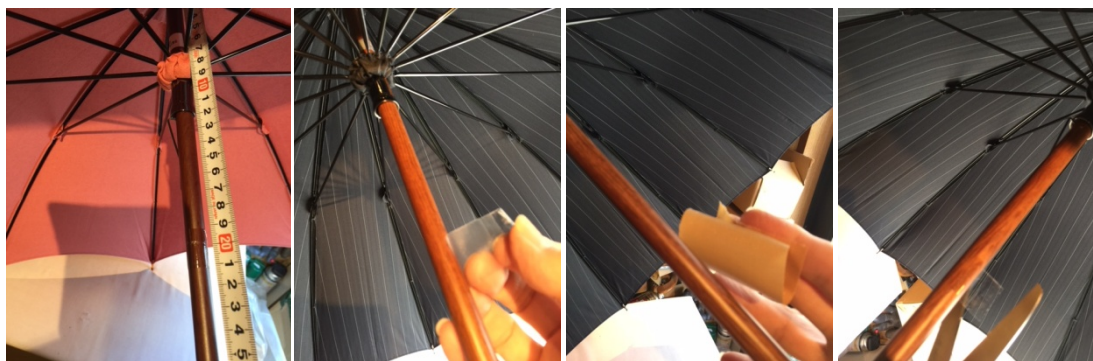
■ターゲットポイントを計測 ■爪で慎重にリムーブ ■布ガムテで糊を除去 ■中棒に垂直に貼れば完成
